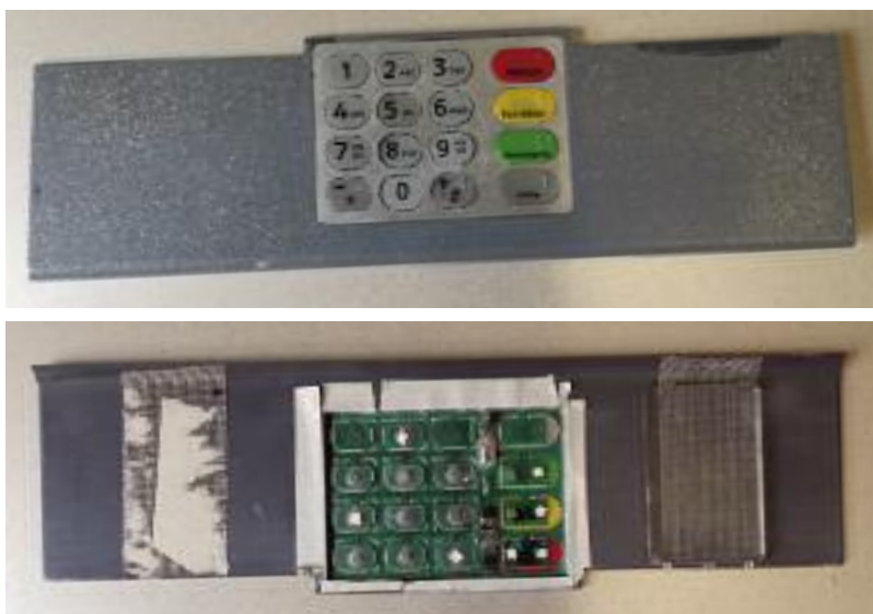
Fake-PIN-Pad: Mit einer falschen, über die echte Tastatur des Bankomaten gestülpten Tastatur wird der PIN registriert und gespeichert.
